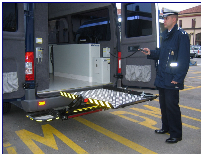
Rampa di accesso per carrozzina disabili
